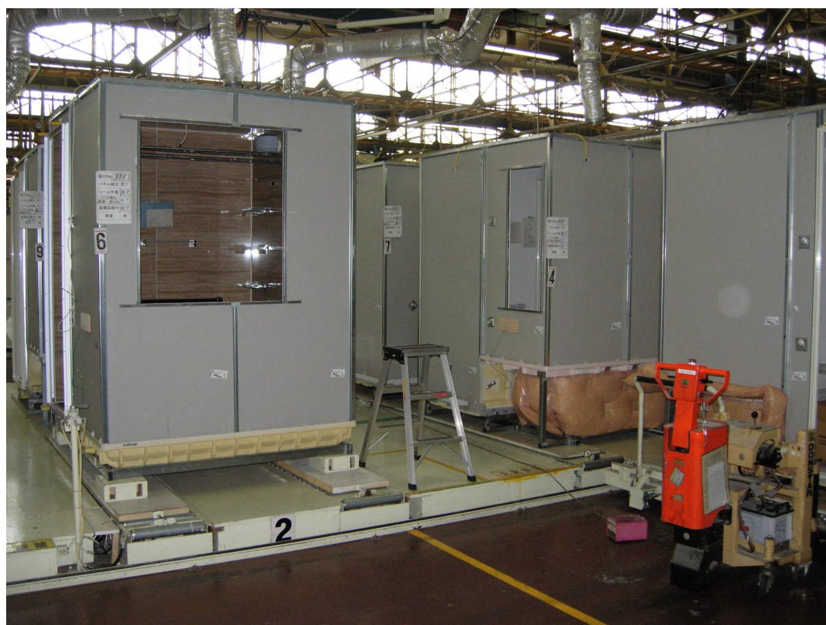
Prefabricerade 3D-moduler i Toyota Homes fabrik i Nagoya.
