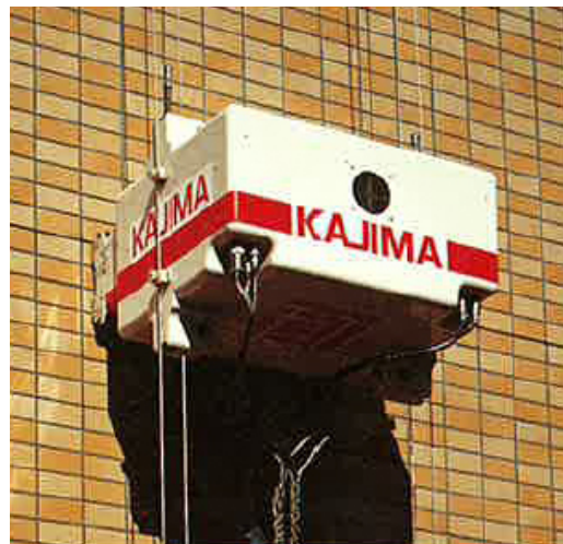
Inspektionsrobot framtagen av Kajima Corporation.
